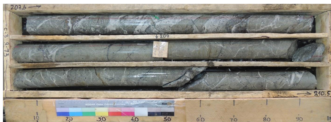
Рис. 9. Жильно-прожилковая система в березитах по песчаникам. Месторождение Лугиинское. Скв. С3, инт. 207,6-210,5 м
