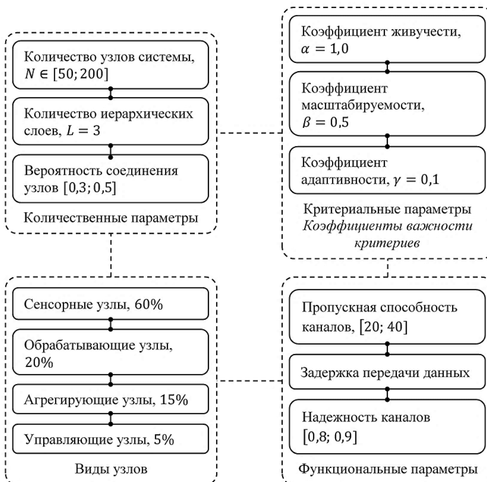
Рисунок 8 – Состав и характеристики СДСС НПМ БР для вычислительных экспериментов
