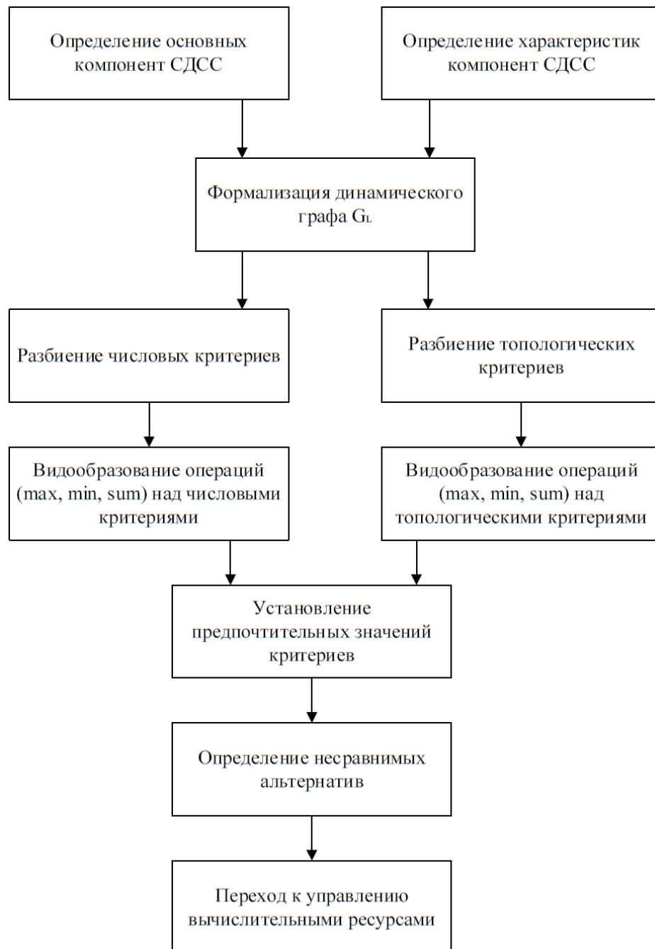
Рисунок 4.23 – Блок-схема алгоритма определения несравнимых альтернатив
