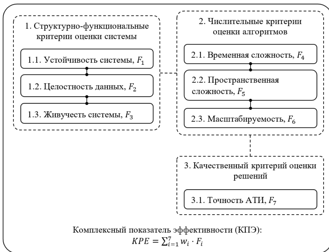
Рисунок 6.2 – Схема оценки эффективности метода реконфигурирования СДСС НПМ БР в соответствии с заданными критериями
