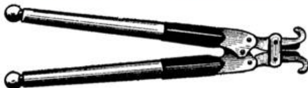
Ножницы длиной 65 см для резки колючей проволоки
