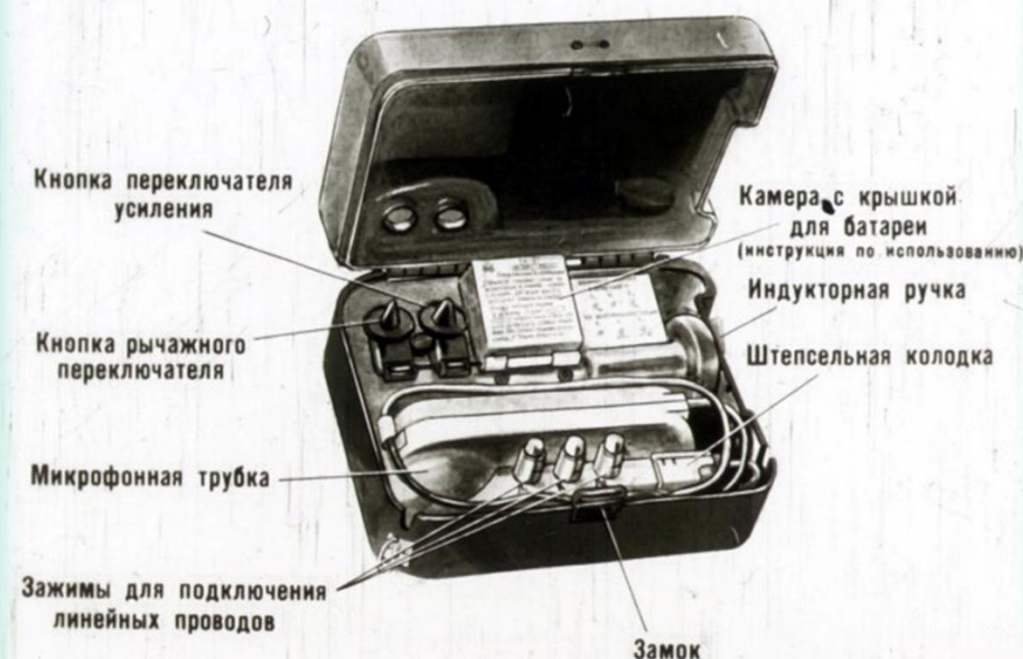
Телефонный аппарат ТА-57 с открытой крышкой
