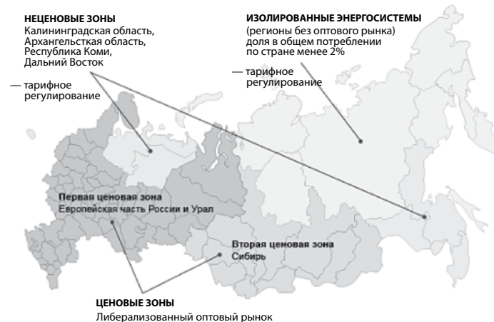
Рис. 3. Ценовые зоны оптового рынка электроэнергии и мощности (по данным НП «Совет рынка»)
