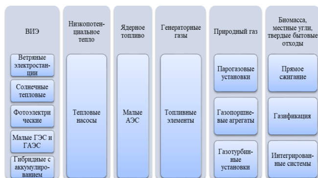
Рисунок 2 - Состав технологий распределенной генерации
