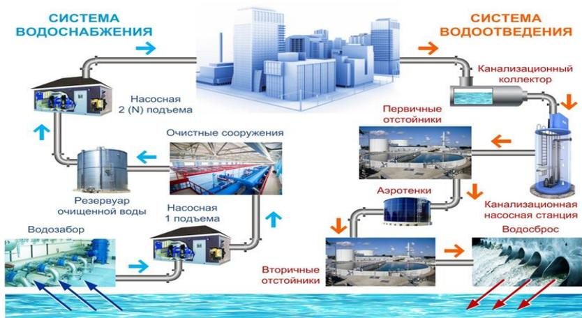
Рисунок 2. Структурная схема водоснабжения и водоотведения
