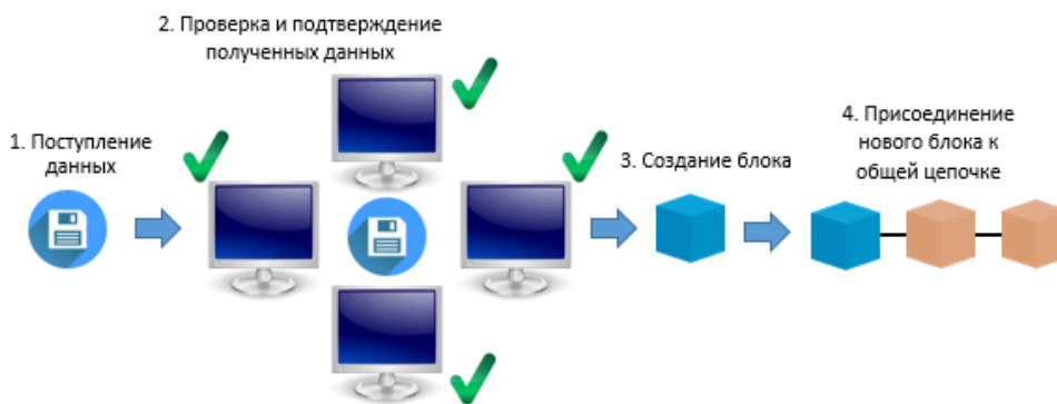
Рис. 1 – Общая схема работы блокчейна. Источник: составлено авторами статьи
