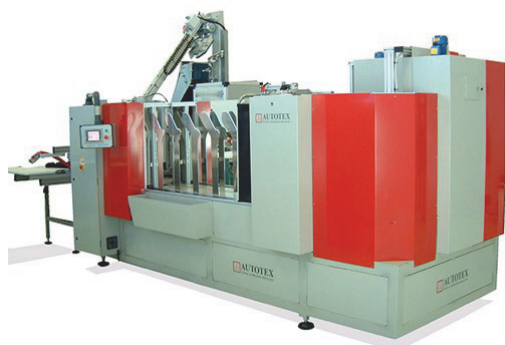
Рисунок 2 - формировочный автомат модель T32 производства фирмы Autotex.
