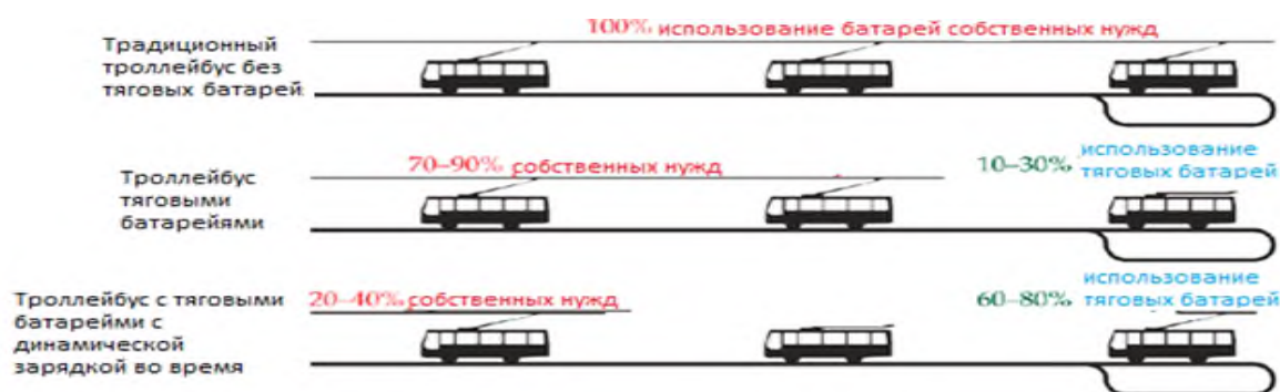
Рисунок 1 – Особенности использования вспомогательных источников питания на троллейбусах
