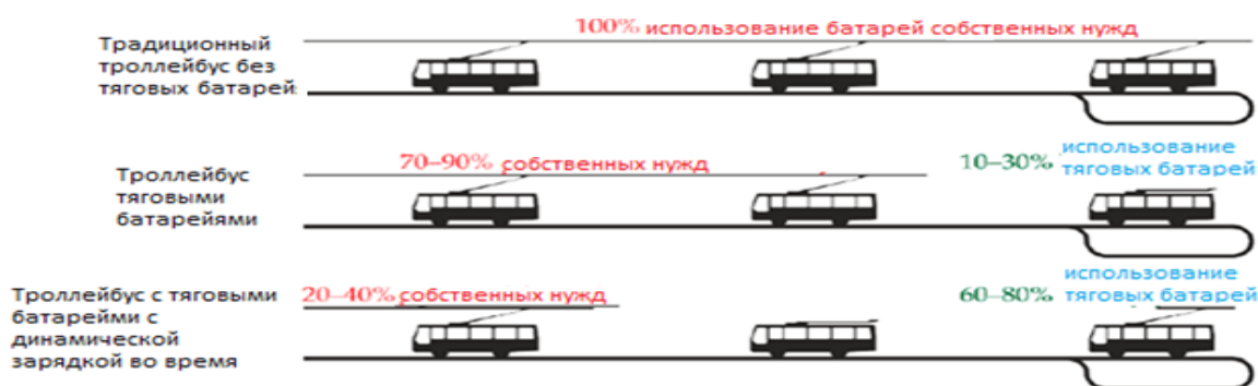
Рисунок 1 – Особенности использования вспомогательных источников питания на троллейбусах
