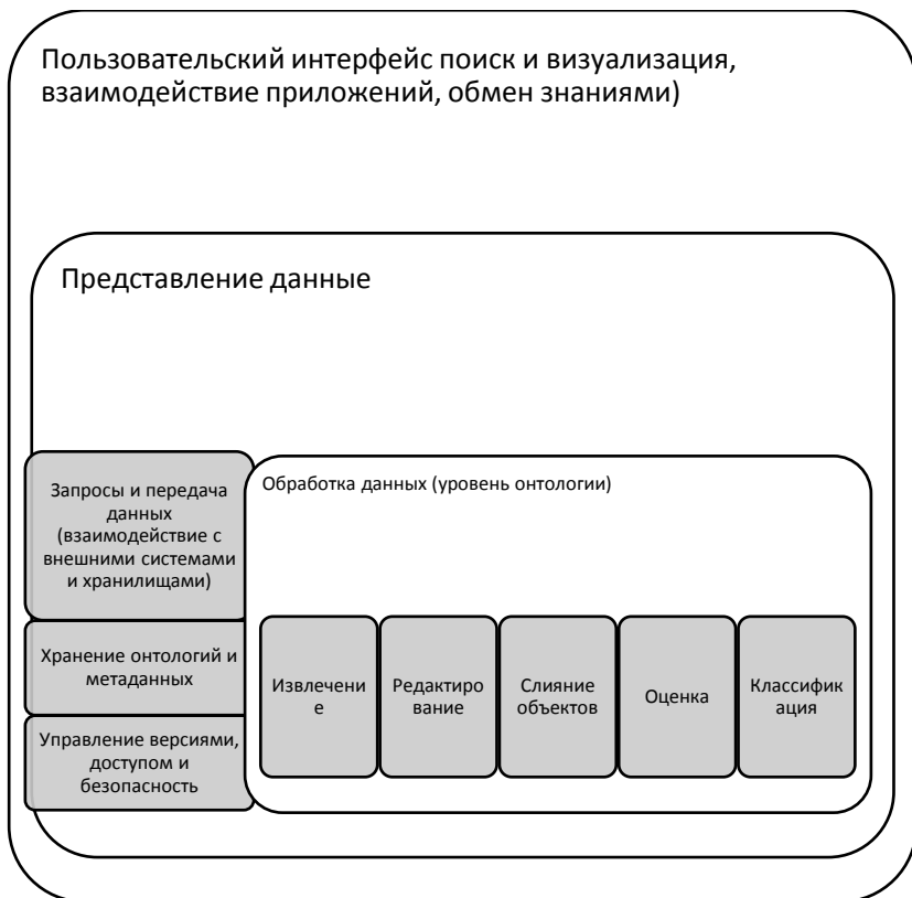
Рис. 2. – Архитектура системы управления данными и знаниями
