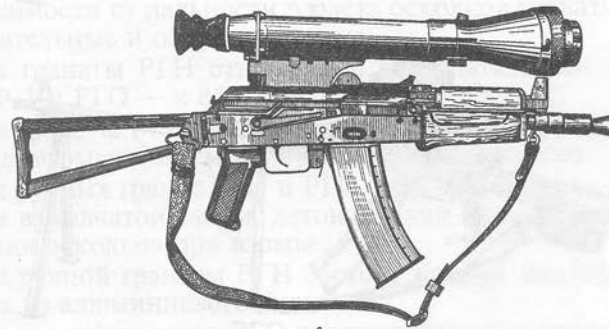
Рис. 17. Общий вид 5,45-мм автомата Калашникова со складывающимся прикладом укороченного (АК-74У): a — с откинутым прикладом; б — со сложенным прикладом; в — с ночным прицелом НСПУМ (АК-74УН2)
