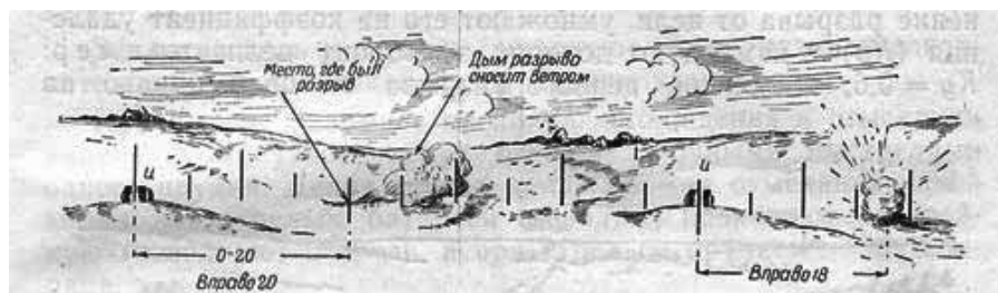
Рис. 6.6. Измерение отклонения разрыва по направлению с помощью сетки бинокля и буссоли.
