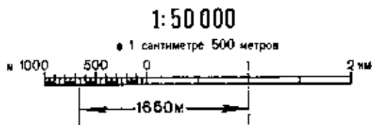
Рис. 11. Численный и линейный масштабы, помещаемые на карте
