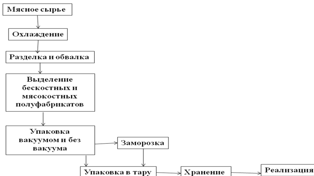
Рис.2. Последовательность производственных операций мяскокомбината Союз.
