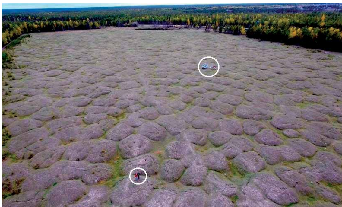
Фото 3. Проявление начальной стадии термокарстовой деградации почвенного покрова на заброшенных пахотных угодьях на ледовом комплексе Для наглядности масштаба трансформации почвы окружностями выделены: на переднем плане – два исследователя, на заднем – автомобиль УАЗ
